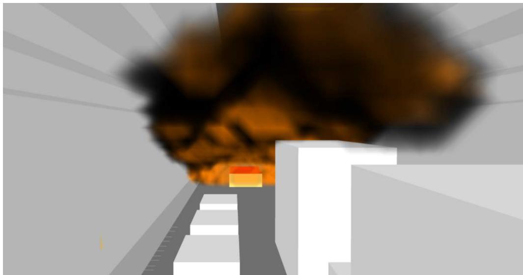
Abbildung 22: Darstellung einer spontanen Freisetzung von Propan im Tunnel Eisgrub (Tunnel Süd, kritische Röhre)
